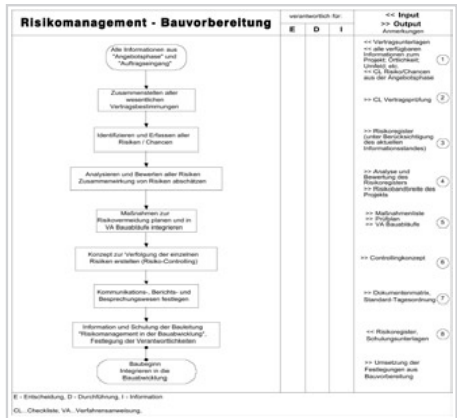
Abb. 2: Ablaufdiagramm „Risikomanagement in der Bauvorbereitung“
