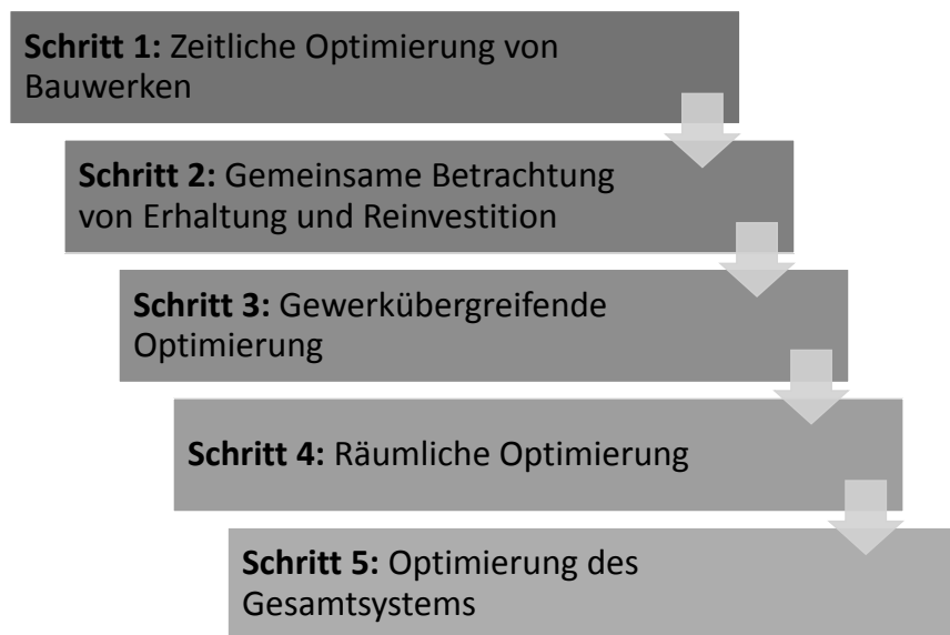
Abb. 3: 5 Schritte der LCM-Optimierung bei der Maßnahmenplanung
